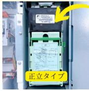
飲料用自販機・酒自販機は左写真の正立タイプとなります。たばこ自販機(グローリー製に多い)は逆さ倒立タイプ(紙幣が下部より挿入されるタイプ)のビルバリが多く採用されています。ご注文の際は正立タイプ・逆さ倒立タイプをご確認してください。逆さ倒立タイプビルバリは受注生産品となります(3ヶ月生産日数)\*\*北海道/沖縄/離島の方は1.000円送料追加となります
